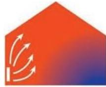
Dans le cas des radiateurs, la chaleur monte, le long des murs et atteint directement le plafond alors que le sol reste froid. De plus, un radiateur impose une température de chauffe beaucoup plus élevée du fait de sa faible surface d'émission par comparaison à la surface de chauffe que représente celle d'un chauffage au sol. Les planchers chauffants HEROTEC, complétés par des plaques de sol Fermacell, permettent de rapidement réaliser une chape sèche flottante.
